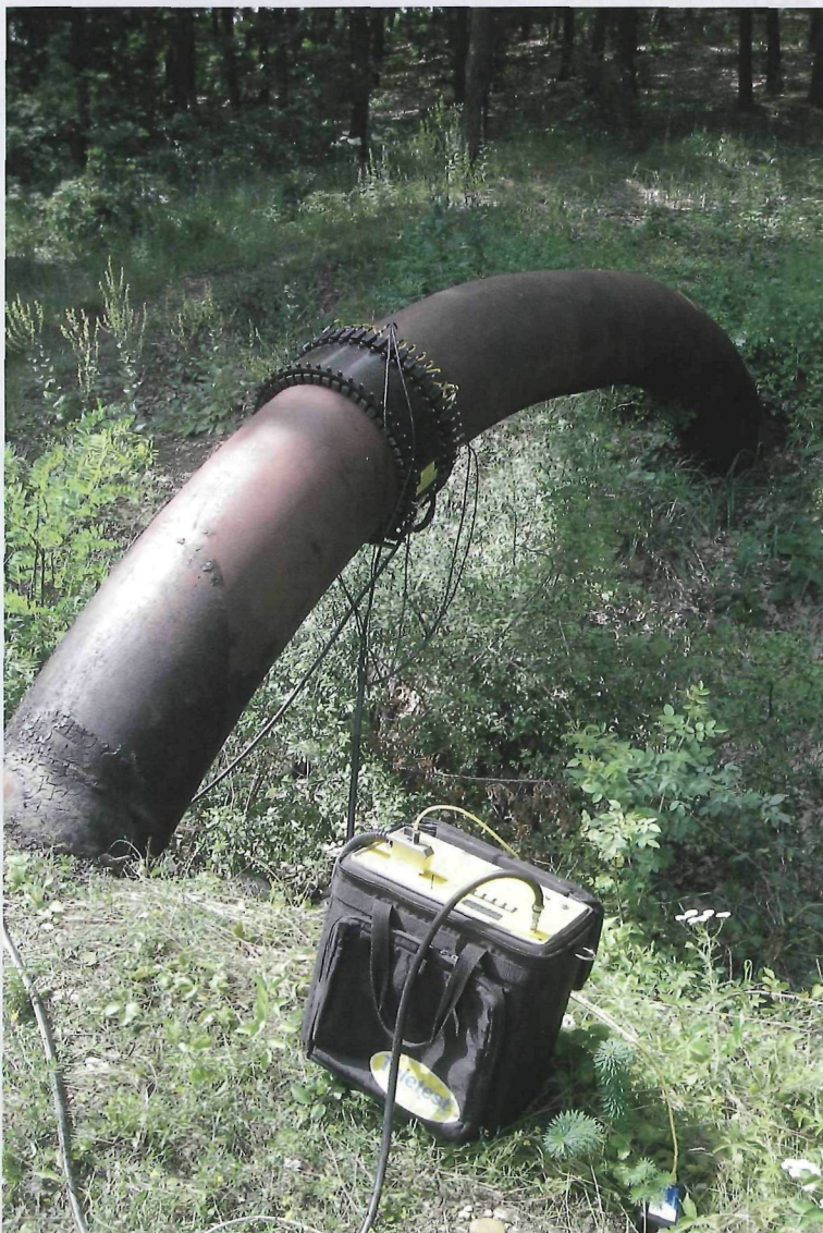
BILD 1: Ultraschallprüfung der Rohrwand in Längsrichtung (LRUT)
