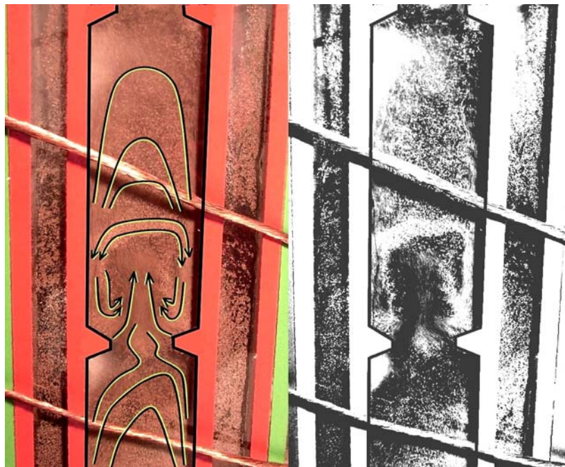
Abbildung 21: Detailaufnahme einer turbulenten Wirbelschichtzone mit erhöhtem Gas/Feststoffkontakt
