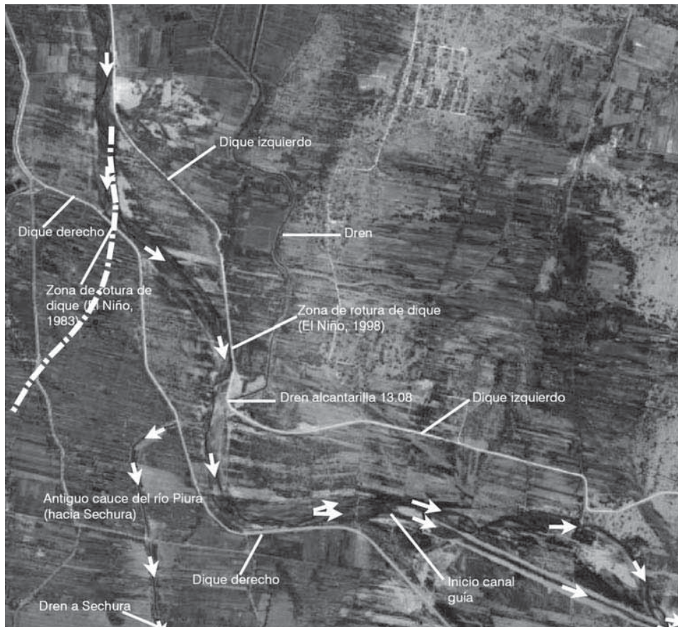
Ilustración 5. Singularidades del encauzamiento del río Piura mostrando las zonas de falla de los diques derecho e izquierdo durante las máximas avenidas de los fenómenos El Niño 1983 y 1998, respectivamente. Obsérvese la zona del antiguo cauce del río Piura en su anterior desembocadura en Sechura. Inferior derecha, inicio del canal guía (construido a fines del 2006) para la rectificación del cauce principal (proyectado el año 2001), en el tramo comprendido entre el final del encauzamiento existente y el ingreso del río Piura a la laguna Ramón.
