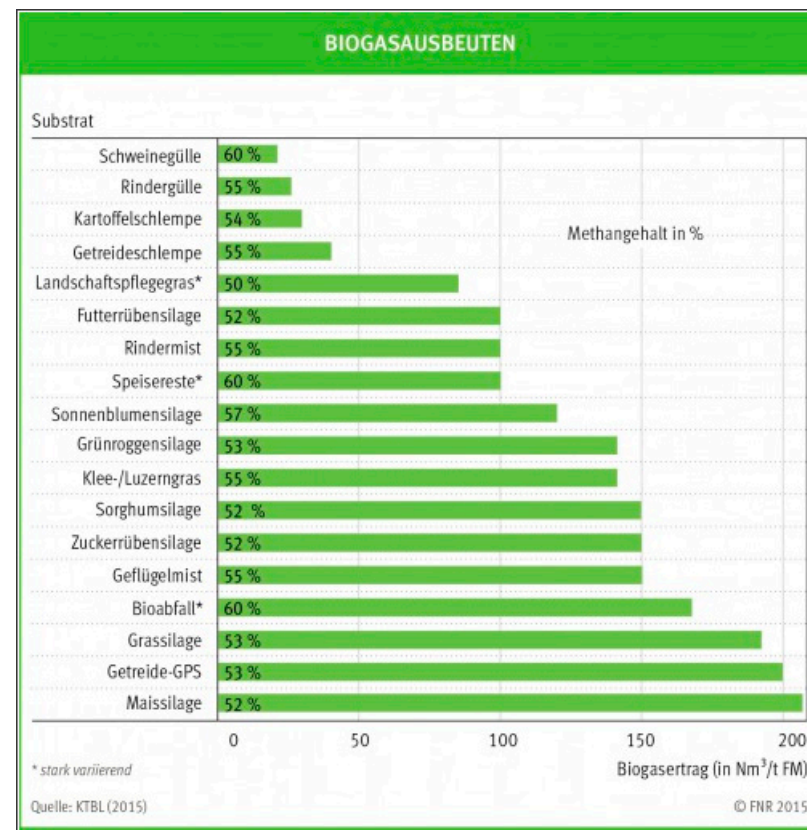
Abb. 3.1.5.1: Biogasausbeuten nach Substrat in \text{Nm}^3/\text{t FM} | Quelle: FNR 2015; KTBL 2015
