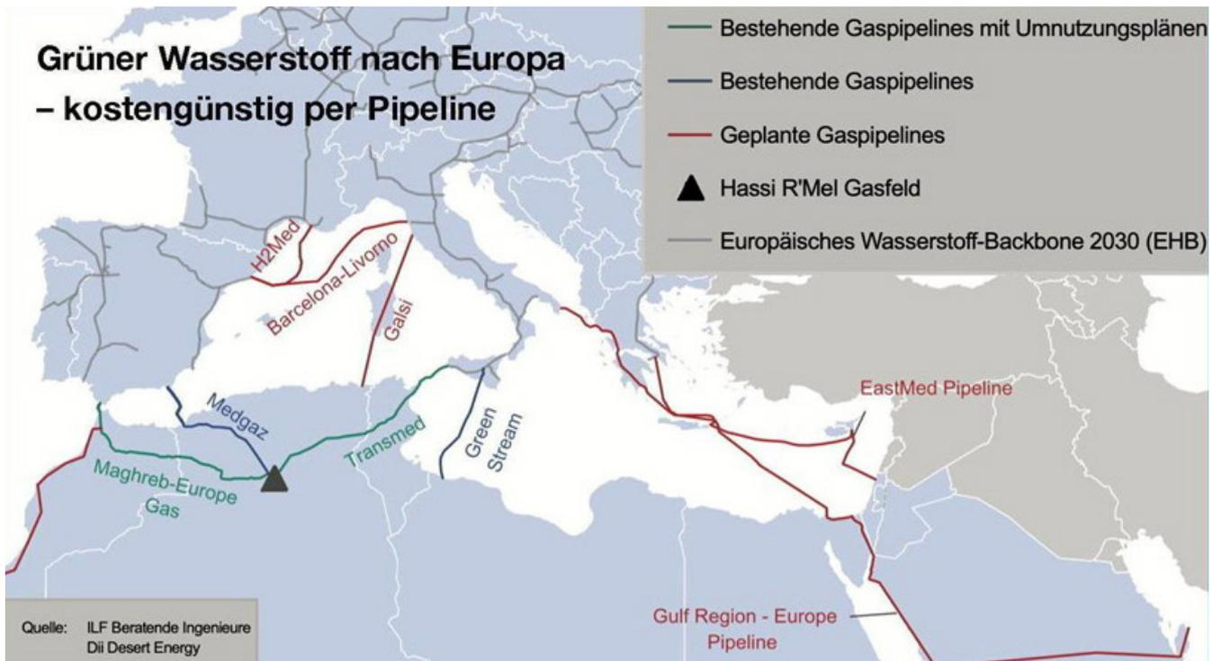
Bestehende und geplante Pipelines durch den Mittelmeerraum sind die günstigste Möglichkeit, emissionsfrei erzeugten Wasserstoff in großen Mengen in das geplante europäische Backbone-Netz (EHB) einzuspeisen. Grafik: ILF/Dii
